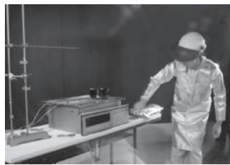
再現テスト室でのIH電磁調理器の実験の様子
