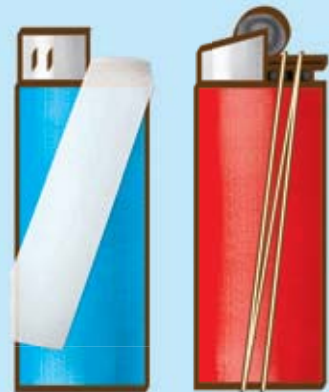
ガス抜きの様子
