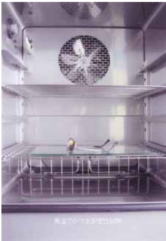
高温での寸法安定性試験
