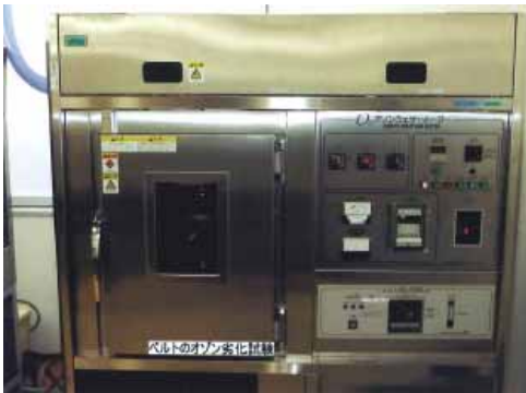
ベルトのオゾン劣化試験
