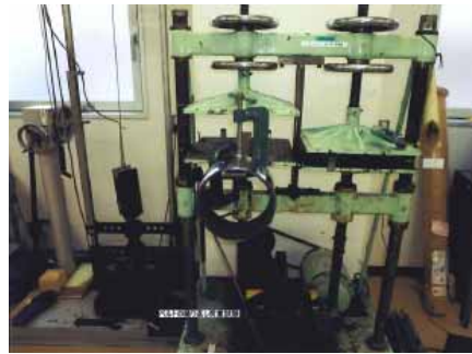
ベルトの繰り返し荷重試験
