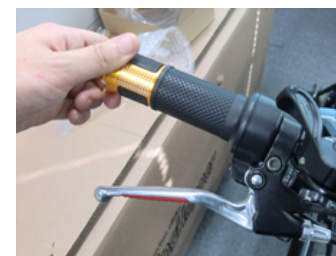
ハンドルを回すと、漕がなくてもモーターのスイッチが入る。
